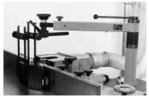
Bild 5: Schutz- und Druckvorrichtung der Suva für das Kehlen am Anschlag.
