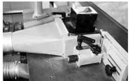
Bild 3: Verdeckung (Schutzkasten) zur Sicherung des Werkzeugs hinter dem Kehlanschlag und zum Auffangen von Staub und Spänen. Der obere Teil kann aufgeklappt werden, so dass ein Werkzeugwechsel ohne Demontage des Schutzkastens erfolgen kann.
