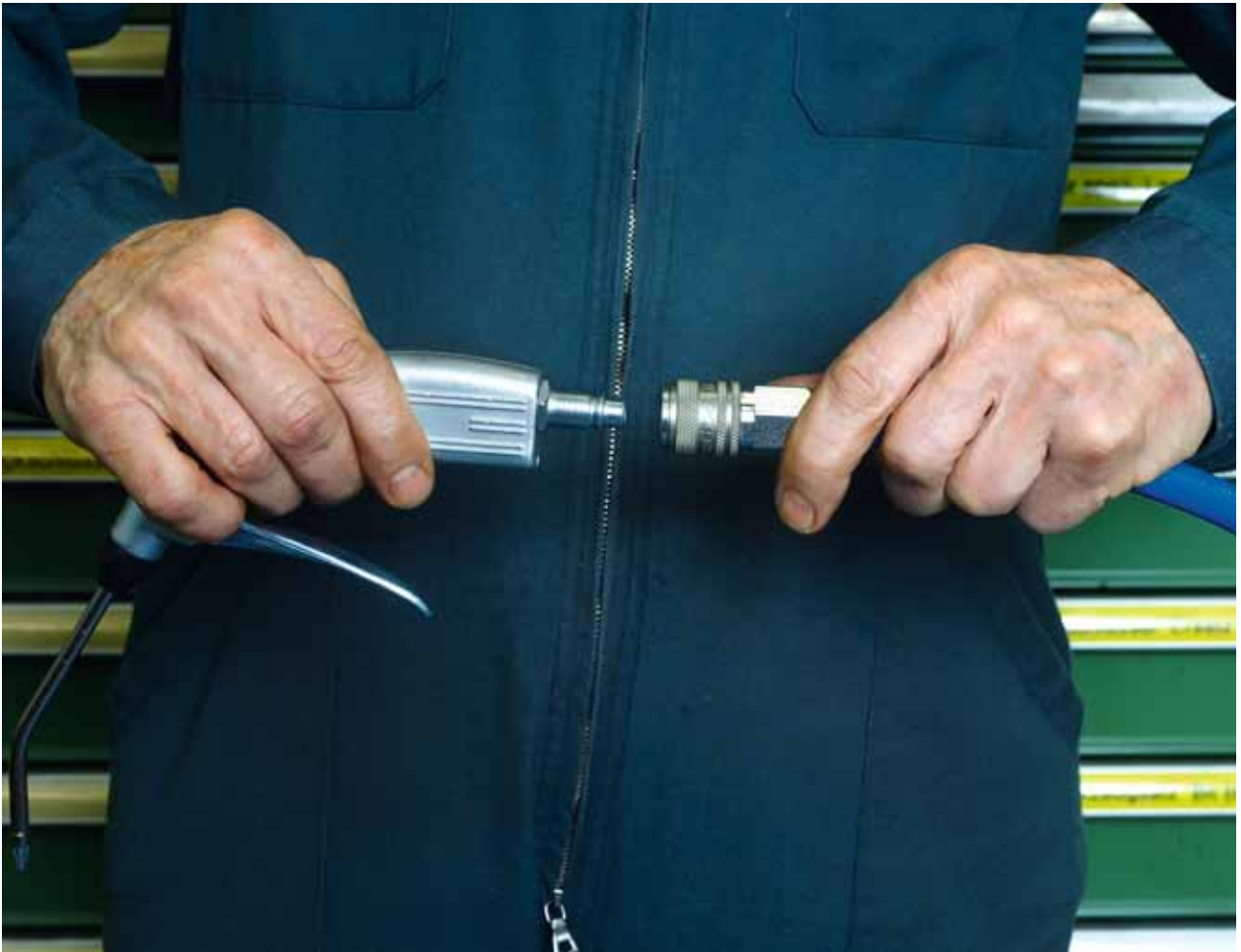
Bild 5: Zum Anschliessen Sicherheits-Kupplungen verwenden.
