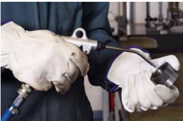
Bild 3: Beim Abblasen Handschuhe tragen.
