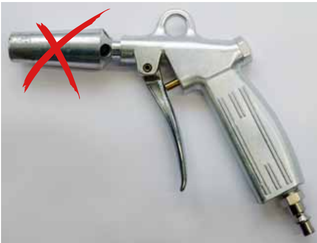
Bild 2: Nicht zulässig: Blaspistole mit Venturidüse.
